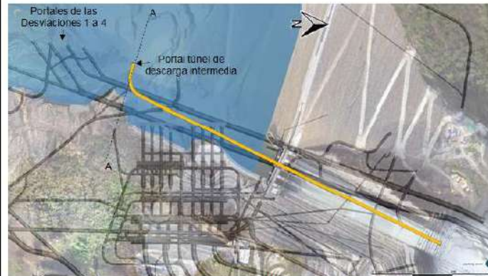
Figura 28. Localización planta portal de la descarga intermedia. Fuente: Consorcio Generación Ituango - CGI, 2022.
