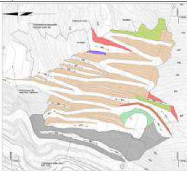
Figura 45 Tratamientos de soporte excavación de la parte alta de la Plazoleta de Compuertas (plano adjunto en su última versión - DC-PHI-052-GAP-EX-C-011 Rev. 4).
