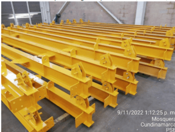
Imagen 2 Vigas transversales del piso
