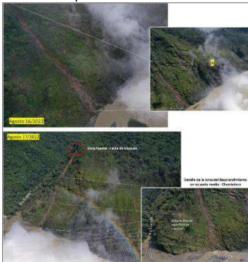
Figura 60 Terrenos aledaños al sector A exhibiendo un movimiento en masa hacia la parte alta de la vertiente
