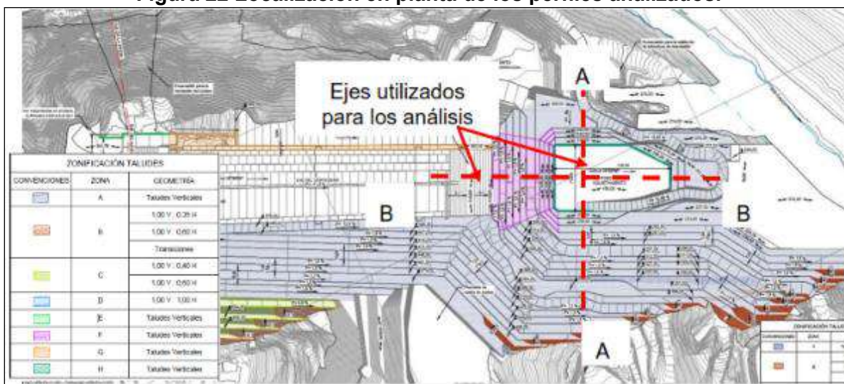
Figura 22 Localización en planta de los perfiles analizados.
