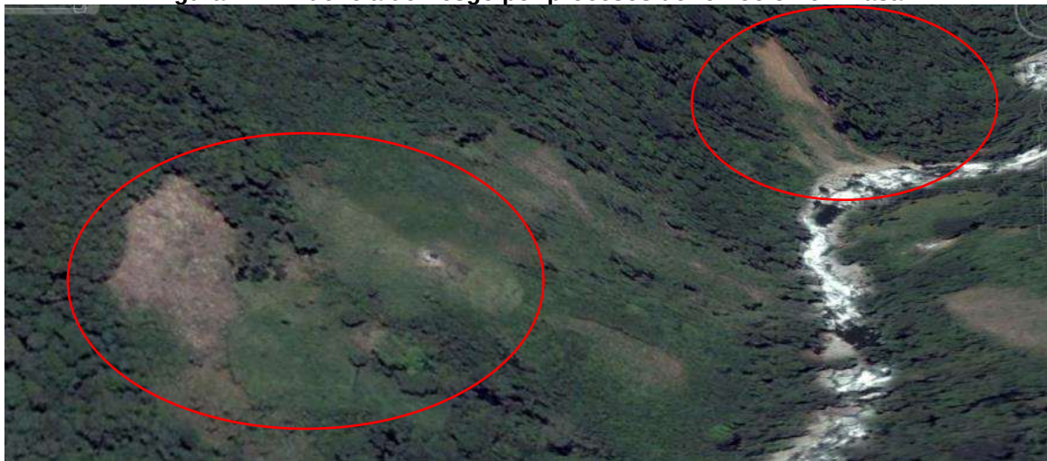
Figura 17. Evidencia de riesgo por procesos de remoción en masa.
