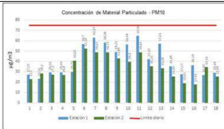
Figura 50. Comportamiento de material particulado PM10 estación 1 (Grúa) y estación 2 (Complejo Sanitario). Fuente: ICA 20, allegado por la Sociedad mediante radicado 2022131016-1-000 del 28 de junio de 2022.
