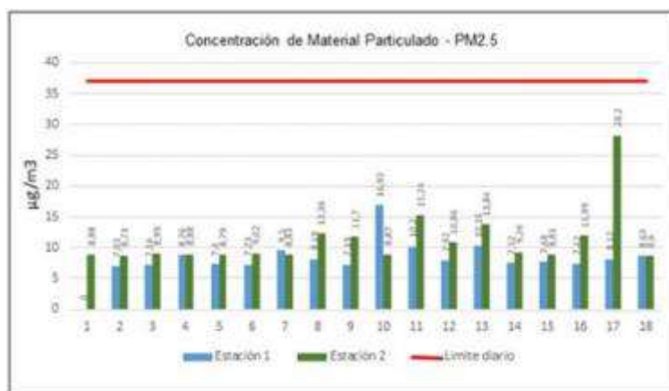
Figura 51. Comportamiento de material particulado PM2.5 estación 1 (Grúa) y estación 2 (Complejo Sanitario). Fuente: ICA 20, allegado por la Sociedad mediante radicado 2022131016-1-000 del 28 de junio de 2022.
