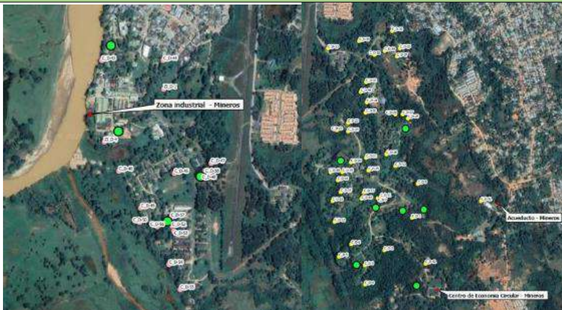
Figura 182. Sistemas sépticos (amarillo) y piezómetros instalados en los campamentos (verde). Fuente: Respuestas requerimientos Auto 11568 del 31 de diciembre de 2021, allegado por la Sociedad mediante radicado 2022088208-1-000 del 6 de mayo de 2022.
