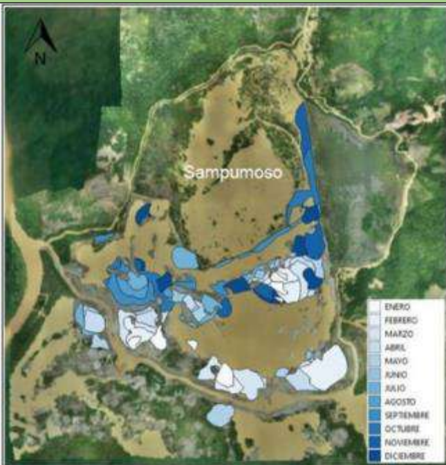
Figura 21. Conformación de rellenos hidráulicos realizados durante 2021.
