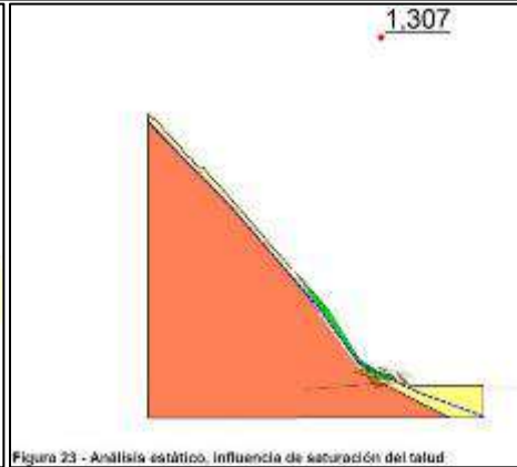
Figura 23 - Análisis estático, influencia de saturación del talud
