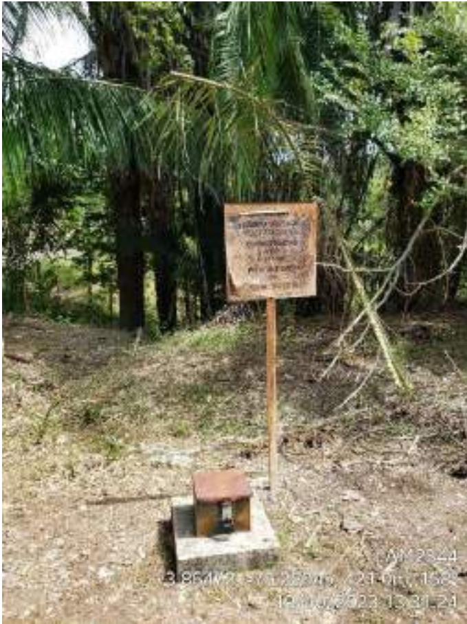
Fotografía 17. Piezómetro 2 del pozo Toldado 2. Nótese el deterioro de la señalización informativa; la legibilidad del letrero es poca. Coordenadas Origen Único Nacional – E: 4746851 N: 1985397.
