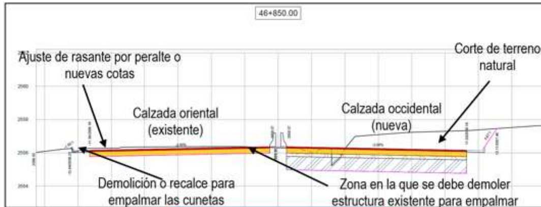
Figura 5. Modificación de rasante, peralte y drenajes calzada existente para conformación segunda calzada
