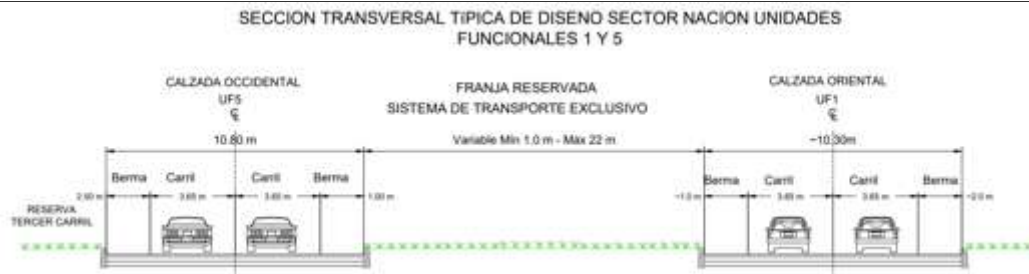
Figura 121. Sección típica transversal UF1 y 5
