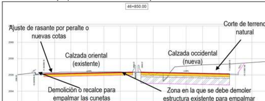
Figura 123. Modificación de rasante, peralte y drenajes calzada existente para conformación segunda calzada
