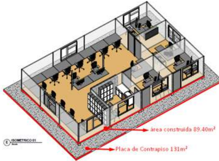
Figura 23 Esquema estructura prefabricada base operacional
