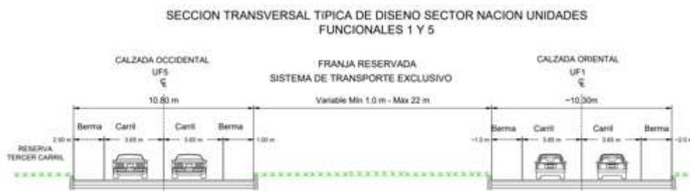
Figura 3. Sección típica transversal UF1 y 5
