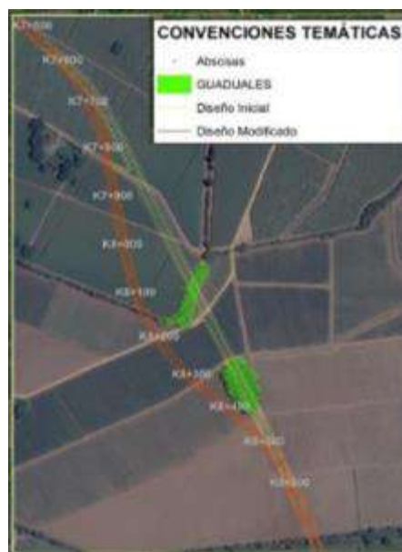
Figura 4 Realineamiento del corredor vial en el sector de las abscisas K08+200 y K08+400
