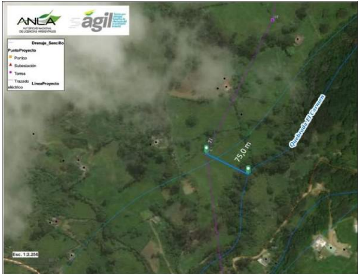
Figura 16 Distancia de la Torre 287 al drenaje sencillo
