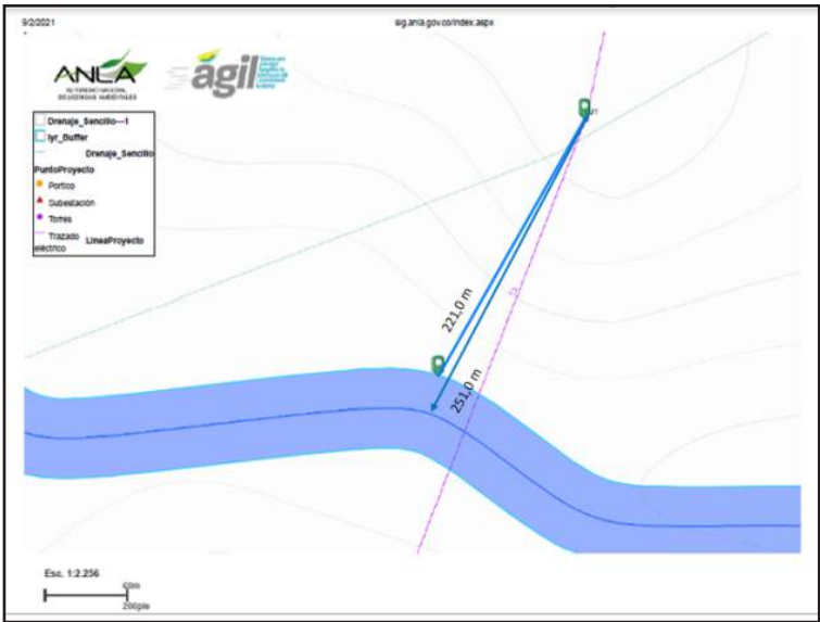
Figura 7 Distancia de la Torre 277 al drenaje sencillo
