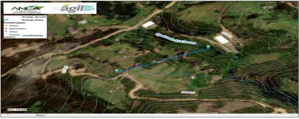
Figura 10 Distancia de la Torre 19 al drenaje sencillo Caño Peroles
