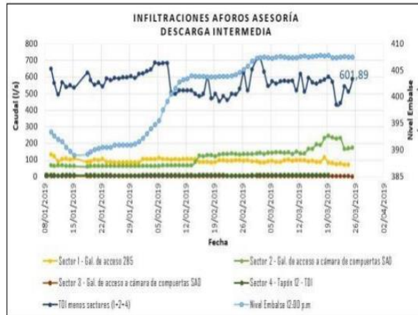
Figura 74 Aforos de las infiltraciones TDI Fuente: retomado del documento “20190611_Reporte_Aforos_TDI.xlsx”- radicación 2019098361-1-000 del 12 de julio de 2019 con numero VITAL 3500081101479819290
